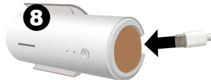
將電源 / 充電線接上 5V2A 以上電源供應器，
